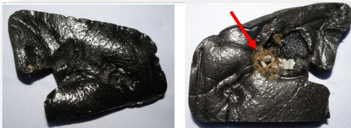
Фотоснимки 4 и 5. Вид неисправных ВЧ-динамиков в автомашине KIA SORENTO. Стрелками показаны следы инородного материала
